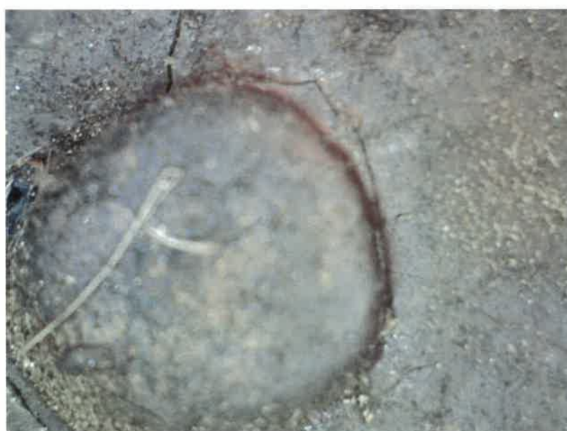
Imagine microscopică produși de coroziune sub prindere vas fier aflat deasupra la coloană balustradă intrare principală – microscop digital portabil
