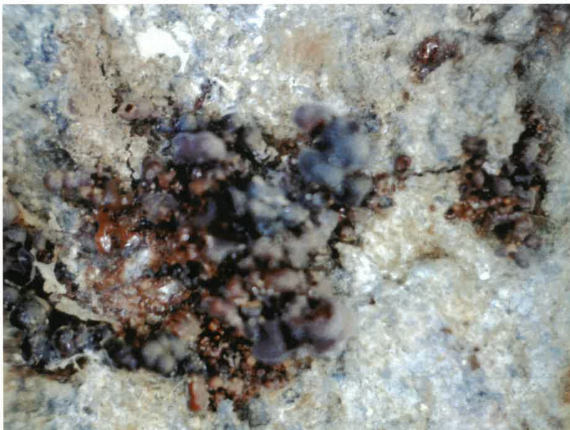
Imagine microscopică produși de coroziune sub prindere vas fier aflat deasupra la coloană balustradă intrare principală – microscop digital portabil
